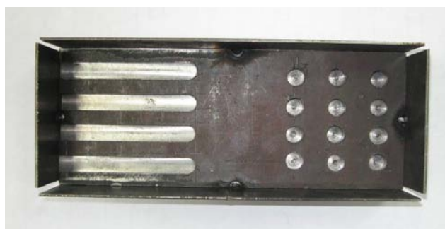
Рис. 2. Образец для контроля толщины изделий
