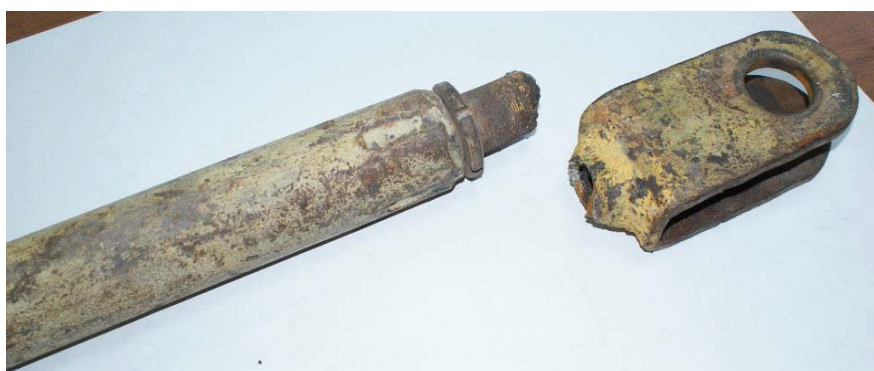
Рис. 38. Образец разрушенного талрепа МКГ 25БР
