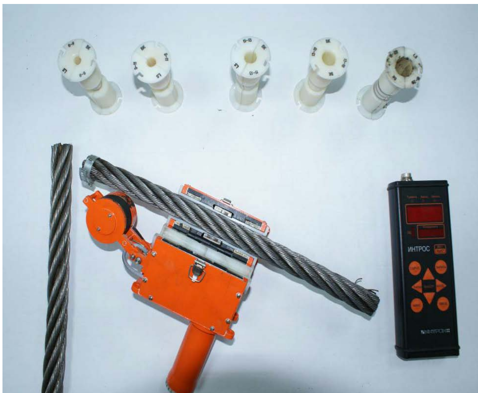
Рис. 29. Измеритель износа с вкладышами и образцами канатов
