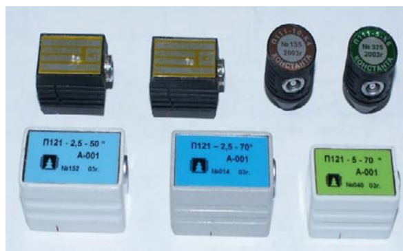
Рис. 23. Пьезоэлектрические преобразователи: а – преобразователи толщиномера ТУЗ; б – преобразователи ультразвукового дефектоскопа
