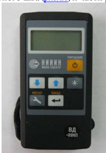
Рис. 18. Дефектоскоп вихретоковый ВД–89НП
