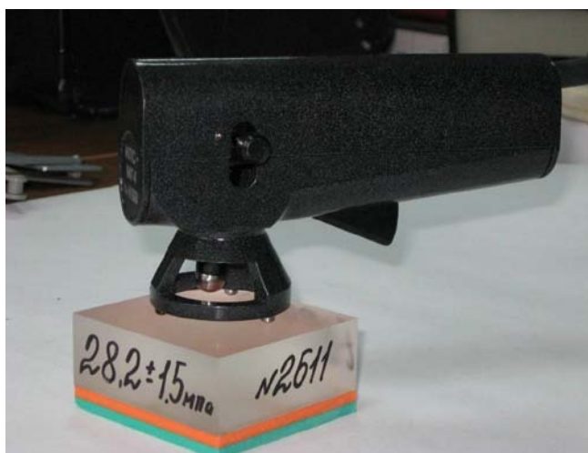
Рис. 30. Склерометр, установленный на контрольном образце
