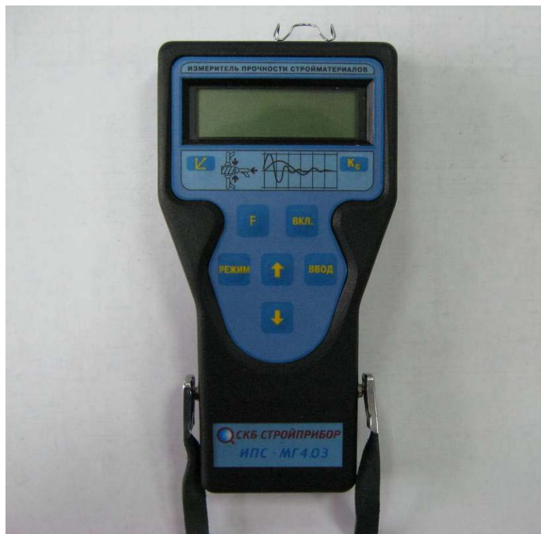
Рис. 31. Электронный блок измерителя твердости
