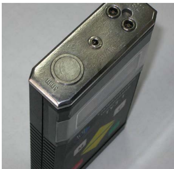
Рис. 5. Контрольный образец (юстировочная плитка) на корпусе толщиномера
