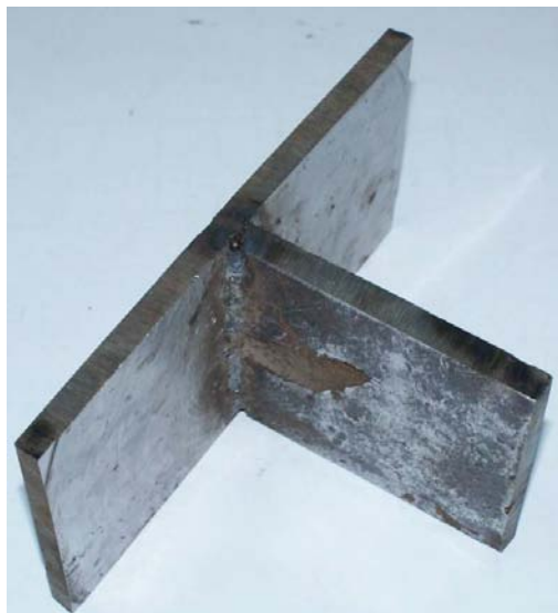
Рис. 25. Образец таврового сварного соединения
