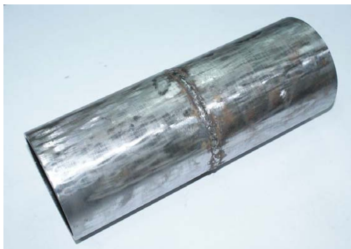
Рис. 20. Образец стыкового трубного шва
