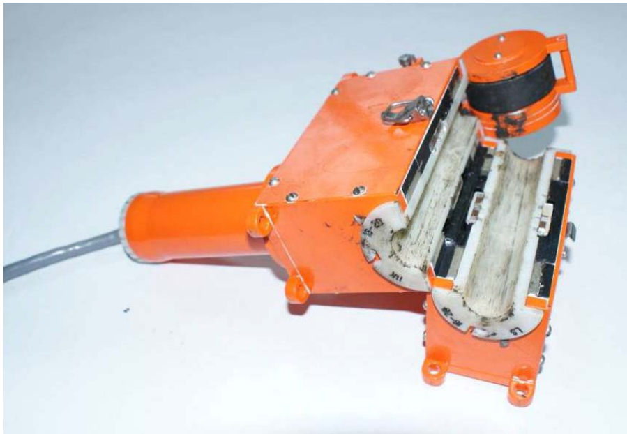
Рис. 28. Магнитная головка измерителя износа
