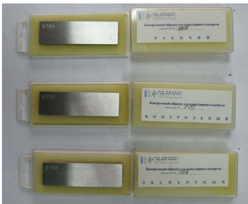
Рис. 15. Контрольные образцы с дефектами
