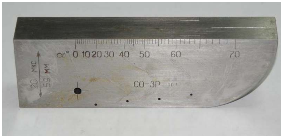
Рис. 24. Эталонный образец КОУ–СО
