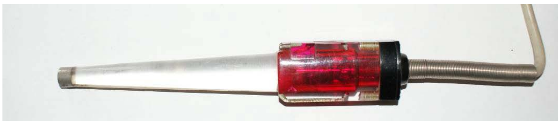
Рис. 34. Наконечник с пьезоэлементами
