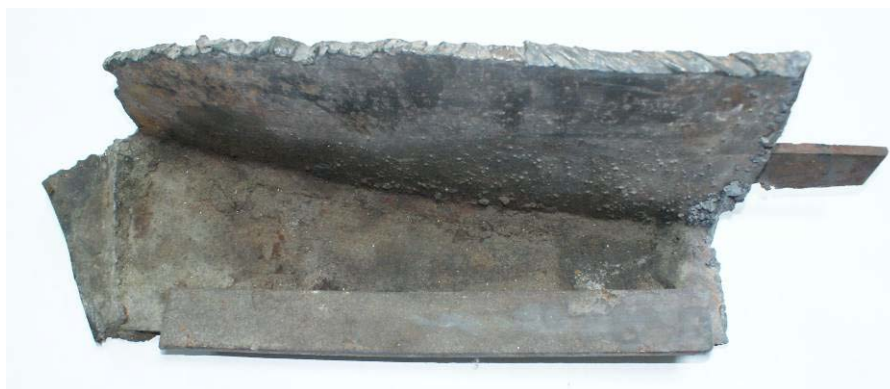
Рис. 37. Образец разрушенного флюгера крана КБ
