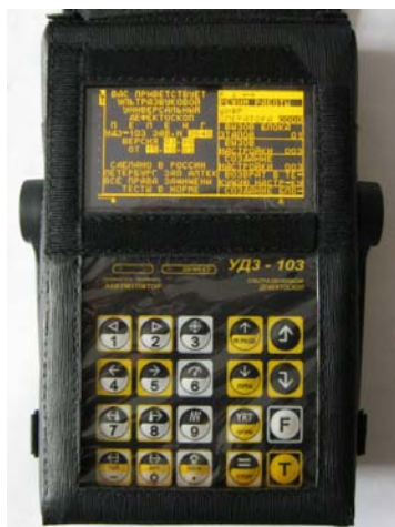
Рис. 22. Ультразвуковой дефектоскоп УДЗ–103
