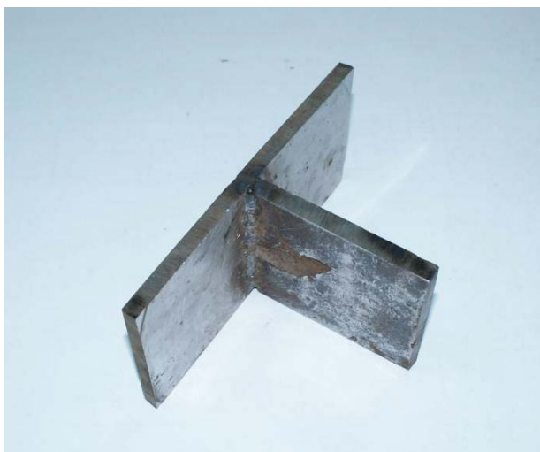
Рис. 19. Образец таврового шва
