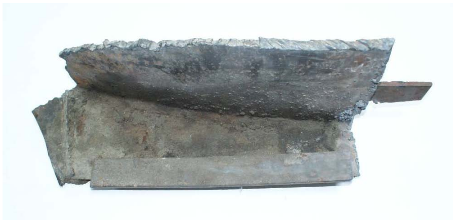
Рис. 21. Образец разрушенного флюгера башенного крана
