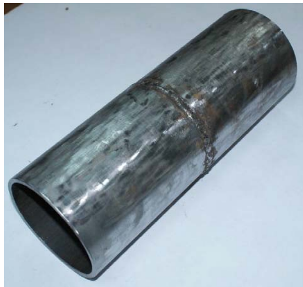
Рис. 26. Образец трубного сварного соединения
