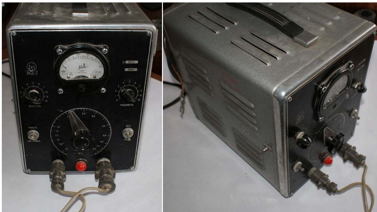
Рис. 33. Импедансный дефектоскоп ИАД-2
