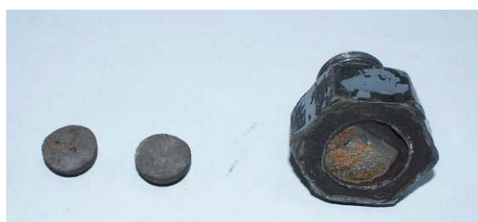
Рис. 39. Разрушенные болт и шарик подшипника крана
