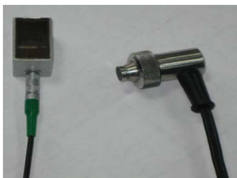
Рис. 23. Пьезоэлектрические преобразователи: а – преобразователи толщиномера ТУЗ; б – преобразователи ультразвукового дефектоскопа
